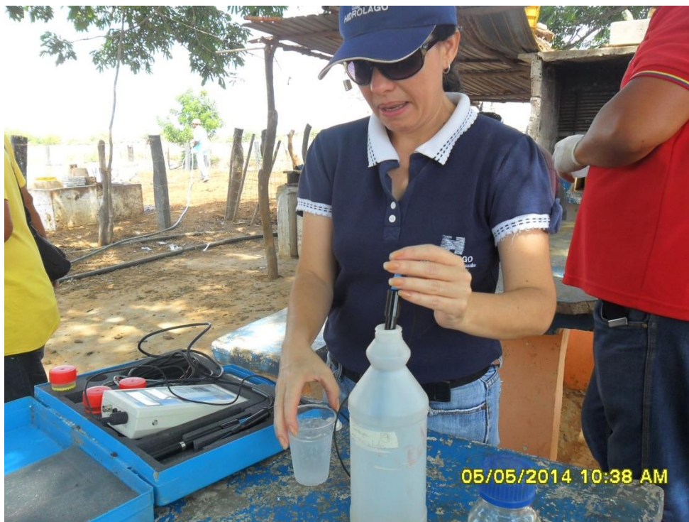
Figura 3. Medición in situ de las propiedades del agua.
