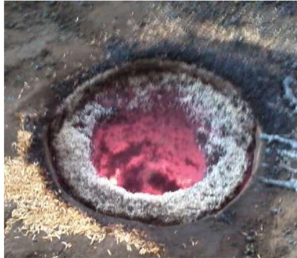
Figura 3. Concentración del rechupe en la superficie de la mazarota convencional.
