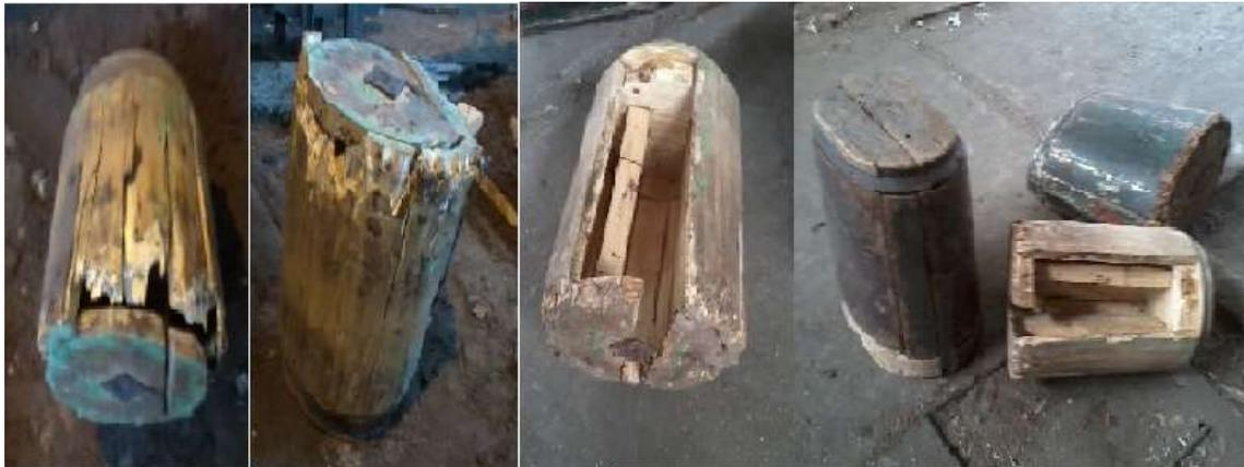
Figura 6. Plantillas de mazarotas deterioradas durante el moldeo en arena.
