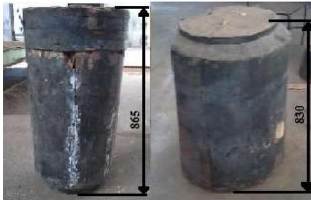
Figura 5. Plantillas para mazarotas de gran altura y tamaño.
