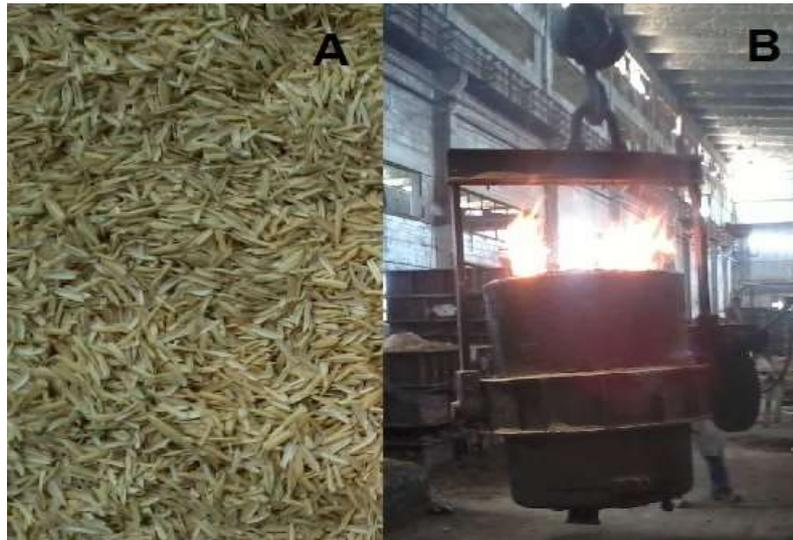
Figura 1. A: Cáscara de arroz utilizada como cobertura, B: Cuchara de vertido con la cobertura de cáscara de arroz en combustión.
