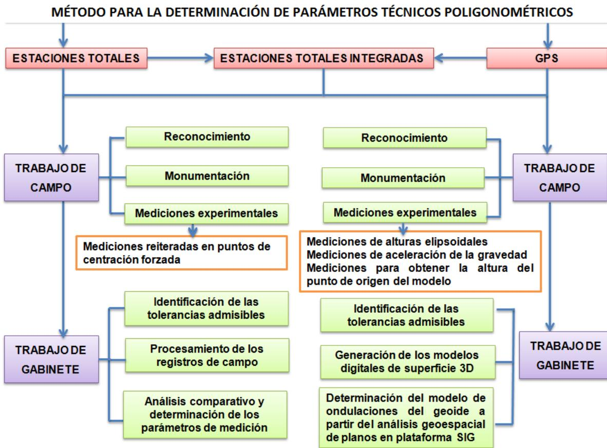
Figura 1. Flujograma que muestra el método empleado en la determinación de los parámetros técnicos poligonométricos (Batista, 2016).
