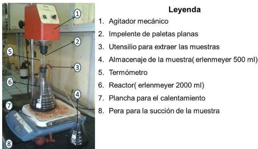
Figura 1. Instalación empleada.
