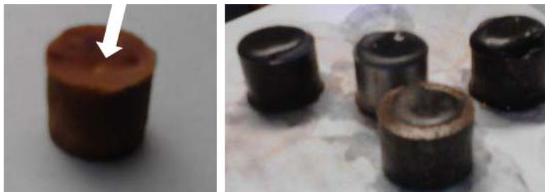
Figura 1. Imágenes representativas de las muestras. a) PMMA sin refuerzo después del desmoldeo; b) PMMA reforzado con polvo de grafito durante la gelificación.
