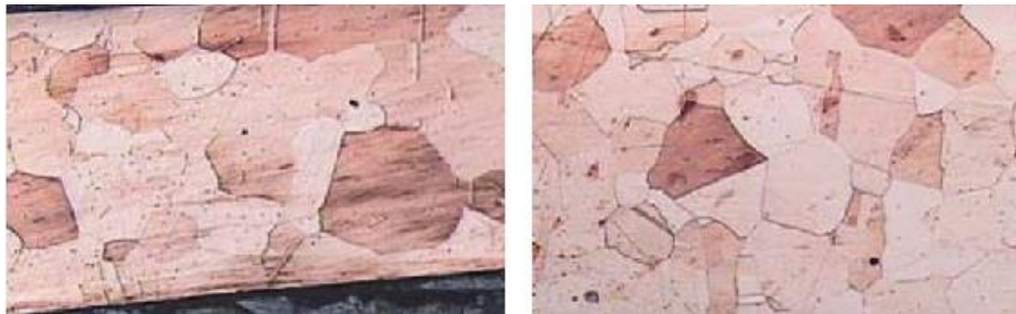
Figura 15. Corte longitudinal del conductor unifilar sección 4 mm 2 .
