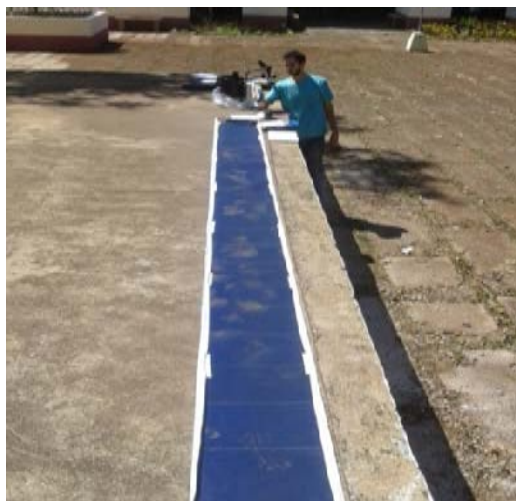
Figura 3. Manta fotovoltaica EPV144S durante su ensayo.
