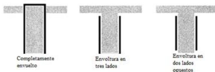
Figura 6. Esquemas de envoltura de refuerzo a cortante (ACI 440.2R, 2008).
