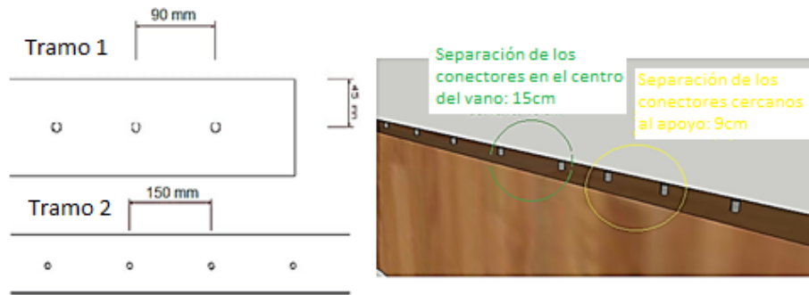
Figura 9. Separación de los conectores para el tramo 1 y tramo 2.
