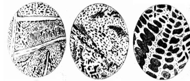
Figura 1. Estructuras de la fundición blanca. Fuente: Rojas et al. (2000).
