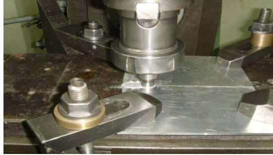
Figura 2. Instalación del proceso de soldadura a tope de la aleación de aluminio.
