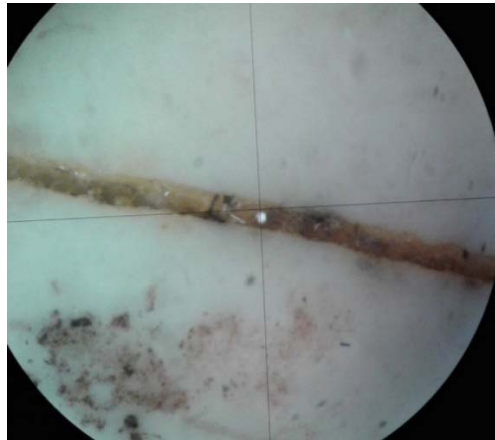
Figura 7. Microfotografía de lámina pulida: Muestra 2 (PEH 9), se aprecia grieta rellena con mineralizaciones metálicas, probablemente birnessita. Se observan los reflejos internos de la calcita (analizadores cruzados).
