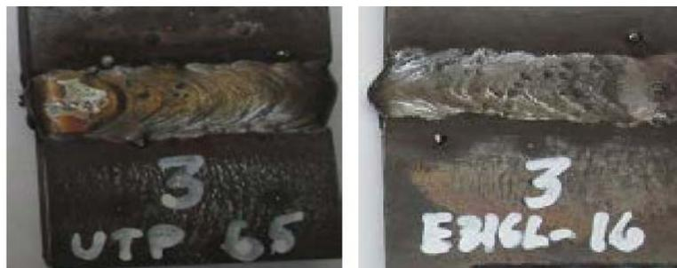
Figura 1 (a). Soldadura con UTP 65. (b). Soldadura con E 316 L-16.
