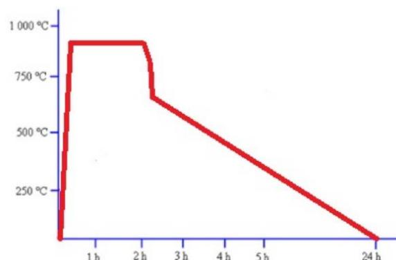
Figura 7. Ciclo térmico de normalizado para la fundición nodular.
