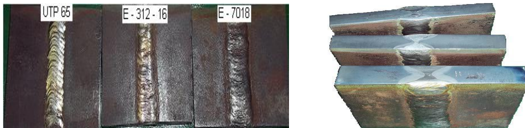
Figura 3. a) soldadura con diferentes electrodos. b) Preparación y soldadura de las muestras.
