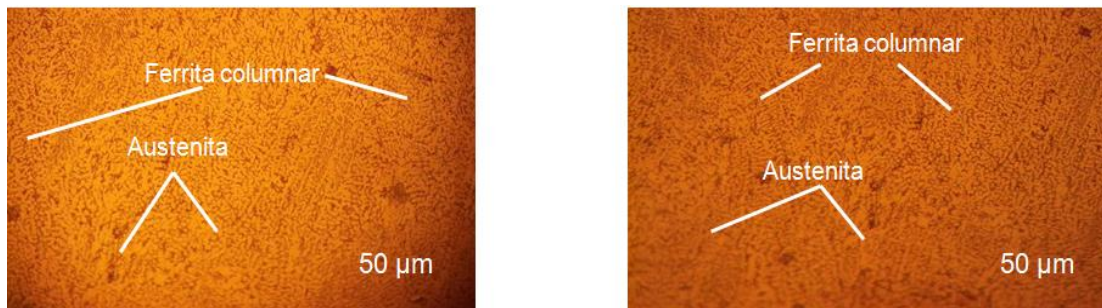
Figura 7. a) Zona de influencia térmica. b) Zona fundida.
