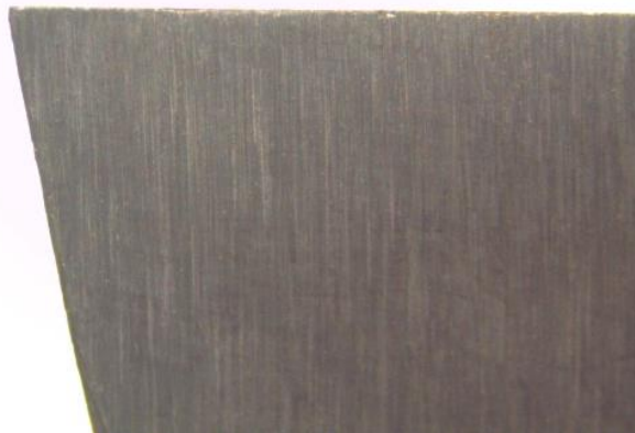
Figura 1. Inspección previa del filo de corte en la superficie de incidencia, con ampliación 20x.
