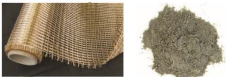
Figura 2. Materiales constituyentes del sistema de FRCM: Tela de malla de PBO y matriz cementicia (Martínez, 2016).
