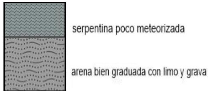
Figura 2. Columna litotipo de los edificios en la zona Costa sur del reparto Miraflores, espesor de 2,20 m.
