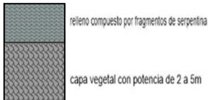
Figura 3. Columna litotipo de las viviendas checas construidas en el reparto Miraflores, espesor de 3,5 m.
