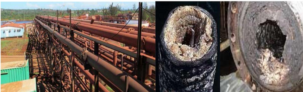
Figura 3. Red de tuberías metálicas y pérdida de capacidad de transportación por la sedimentación de las pulpas de la planta Pedro Sotto Alba.
