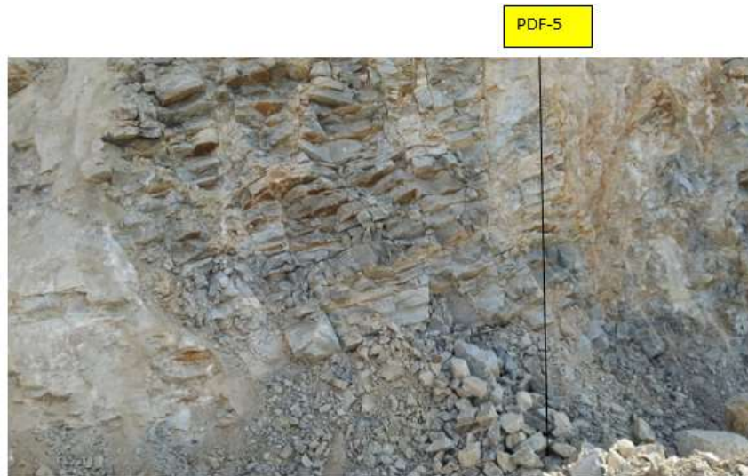
Figura 2. Macizo ubicado en el sector oeste de Victoria II con dirección de explotación paralela al rumbo por el bloque yacente, se observan areniscas calcáreas de granos finos, color gris claro estratificación media a fina.
