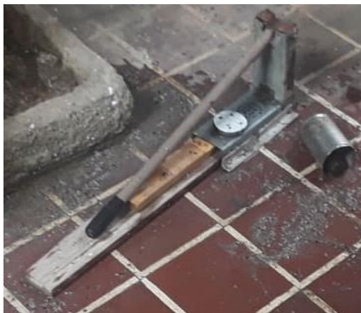
Figura 1. Prensa de palanca utilizada para la fabricación de las probetas.
