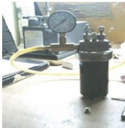
Figura 4. Bomba calorimétrica de Malher utilizada para hallar el poder calorífico de las muestras de briquetas.
