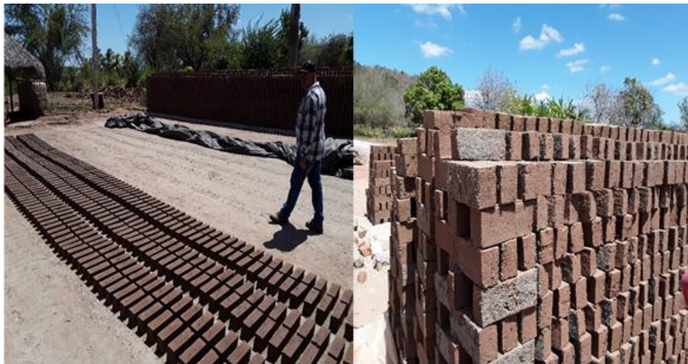
Figura 5. Pequeña producción de ladrillos cerámicos a partir de las arcillas de Las Matenca.
