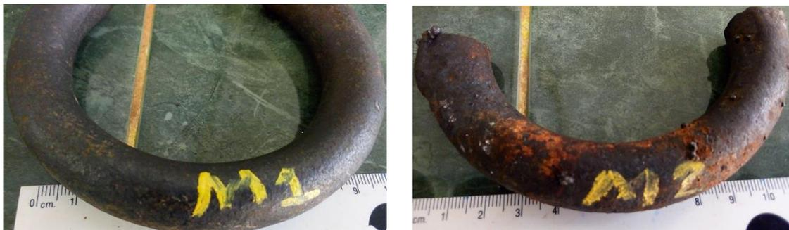
Figura 1. Eslabón en estado de suministro. Figura 1a. Eslabón retirado de servicio.
