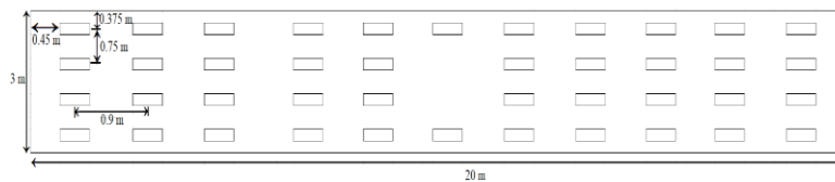
Figura 5. Distribución final del local con lámparas LED.
