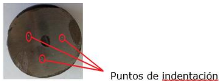
Figura 4. Zonas de medición de dureza.
