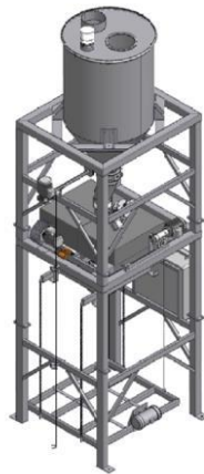
Figura 1. Dibujo 3D de la unidad ensacadora TEKFA, modelo S20494, ubicada en la ECG, fabricada en Dinamarca.
