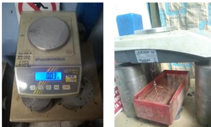
Figura 4. a) Balanza y soporte (inserto al aire). b) Balanza y soporte (inserto en agua).
