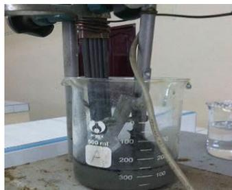
Figura 2. Revelado de la estructura por electrolisis.
