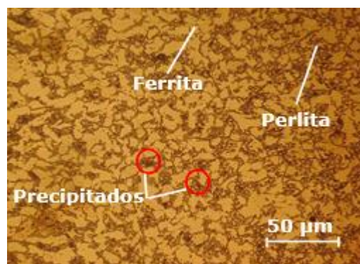
Figura 4. Estructura del acero estructural ASTM A-615 grado 60 G.
