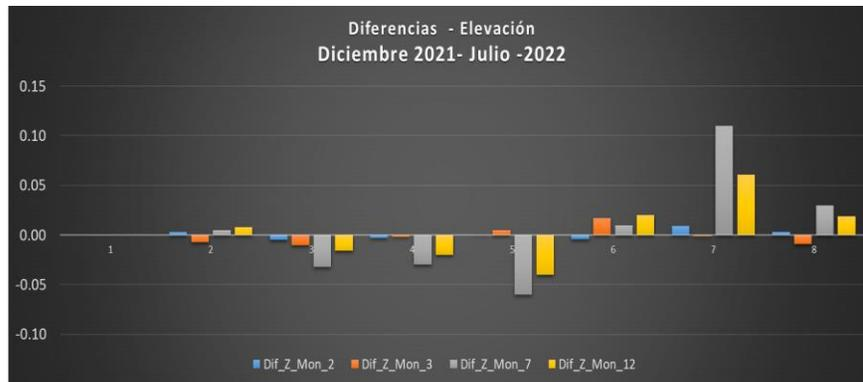
Figura 7. Resultados del control de los monumentos topográficos, dirección vertical (z).
