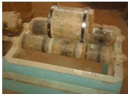
Figura 5. Molino de bolas empelado para molienda de la arcilla calcinada.
