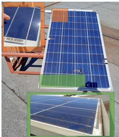
Figura 12. Acumulación de polvo resultado de la exposición del módulo SW 150 poly R6A/D a las condiciones climáticas de Moa.
