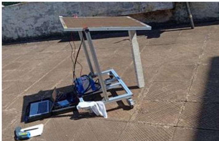
Figura 7. Panel con 21 g de polvo depositado en su superficie, trazador de curvas, laptop con aplicación para la toma de datos y estación climatológica.
