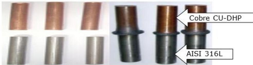
Figura 2. a). Barras para la unión. b). Unión realizada por fricción.
