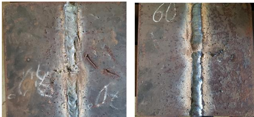
Figura 1. a) Soldadura con bisel a 30°. b) Soldadura con bisel a 35°.
