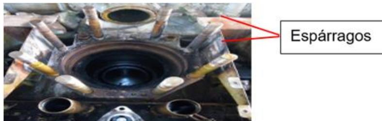
Figura 2. Disposición de los tornillos en el motor.
