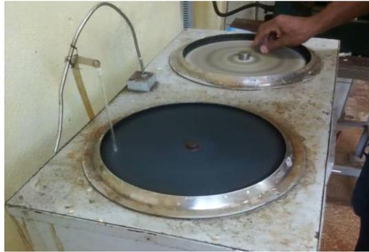
Figura 3. Lijado fino de las muestras metalográficas.
