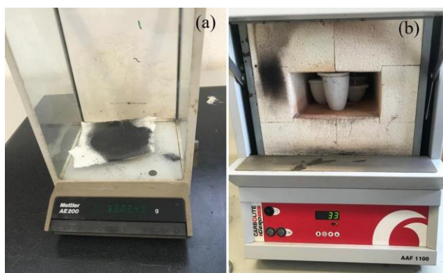
Figura 1. a) Demostración del pesaje de la muestra utilizando la balanza técnica. b) Calcinación de carbón vegetal en el horno de mufla utilizando crisoles.
