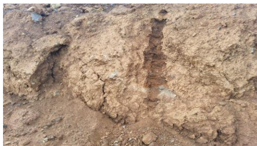
Figura 4. Método de surco para el muestreo de las menas lateríticas en las pilas de las plazoletas.
