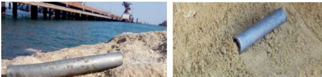
Figura 3. Muestra a) expuesta a la superficie. b) al ser enterrada.
