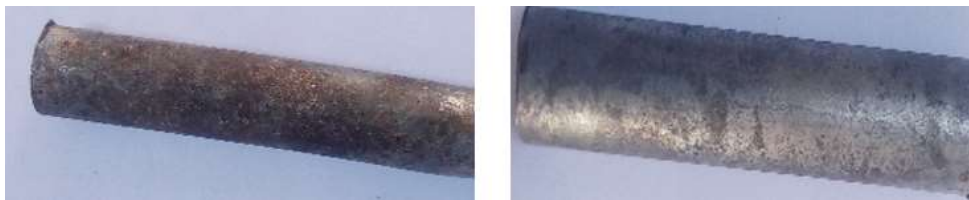
Figura 4. Grado de oxidación de la muestra. a) Muestra A. b) Muestra B.
