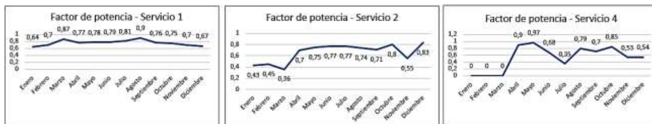
Figura 8. Comportamiento del factor de potencia en los servicios 1, 2 y 4 durante 2023.
