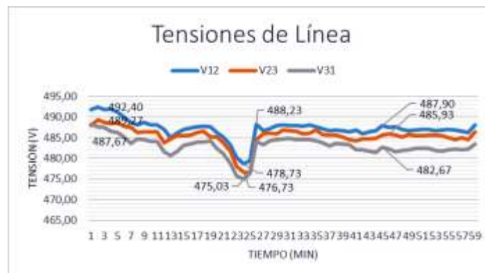
Figura 2. Comportamiento de las tensiones de línea.
