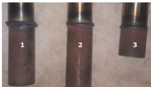
Figura 3. Unión disímil obtenida de la soldadura por fricción.
