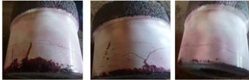
Figura 6. Defecto tipo poros.
