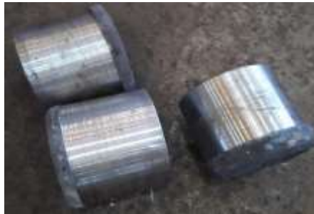
Figura 1. Rodillos maquinados luego de un tratamiento de recocido.
