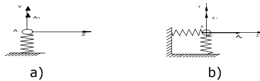
Figura 2. Esquema de análisis del apoyo articulado a) Elástico móvil. b) Elástico fijo.
