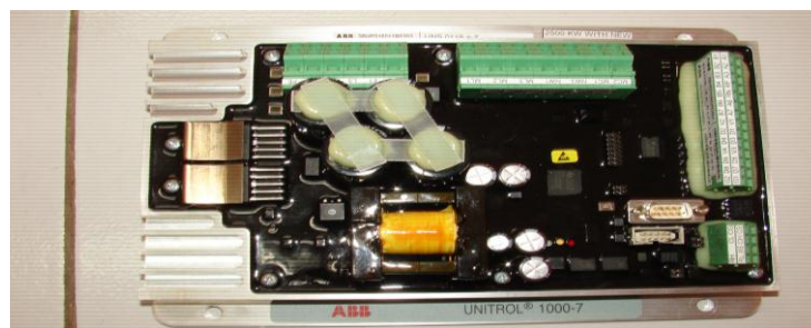
Figura 3. Regulador Automático de Voltaje (AVR).
