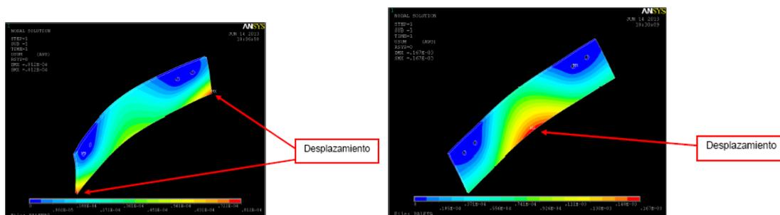
Figura 3. Desplazamientos de la paleta a) con ángulo de  $14^\circ$ . b) con ángulo de  $28^\circ$ .
