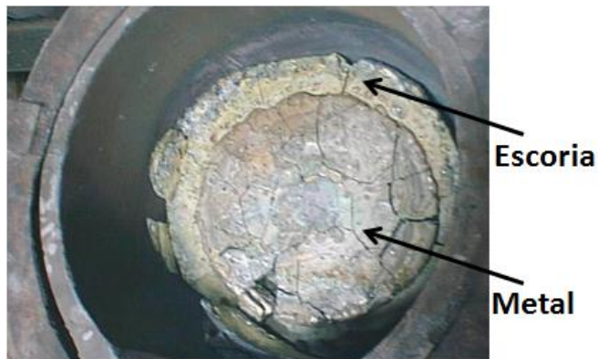
Figura 5. Metal obtenido en la colada rodeado de una capa de escoria.
