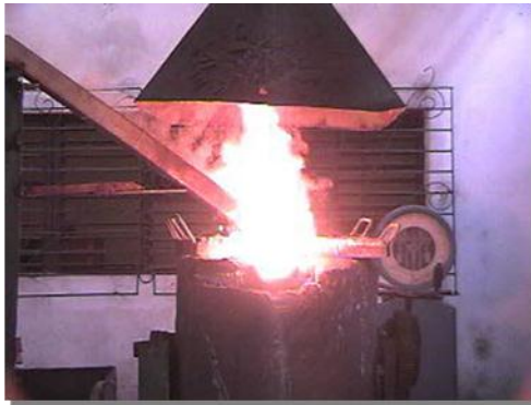
Figura 4. Procesamiento aluminotérmico a escala de planta piloto.
