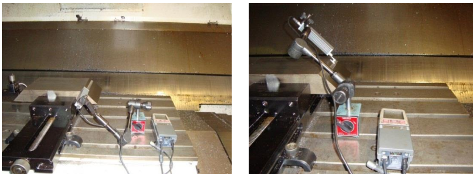
Figura 1. Obtención del perfil de rugosidad en sentido longitudinal y transversal a la dirección del avance de la herramienta con el rugosímetro portátil Mitutoyo modelo SJ-201P.
