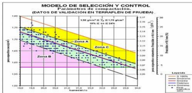
Figura 8. Modelo de selección y control de los parámetros de compactación validado en el terraplén de prueba.
