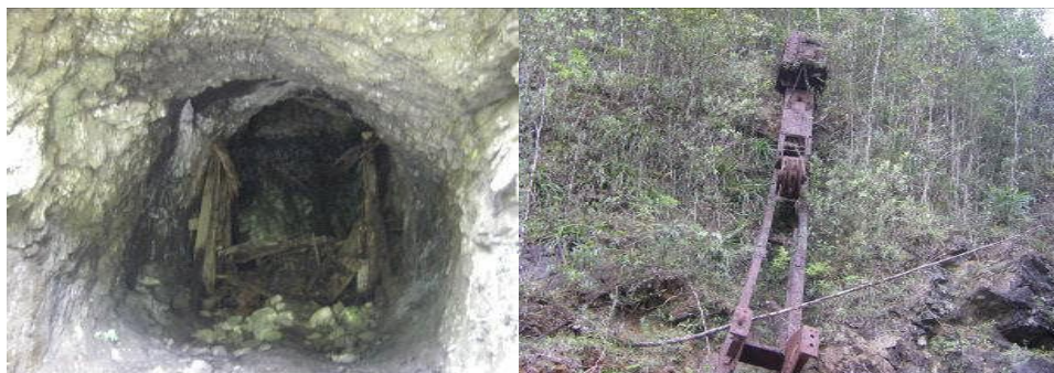
Figura 3. Galería de la mina de cromo y plano inclinado para el transporte de mineral.
