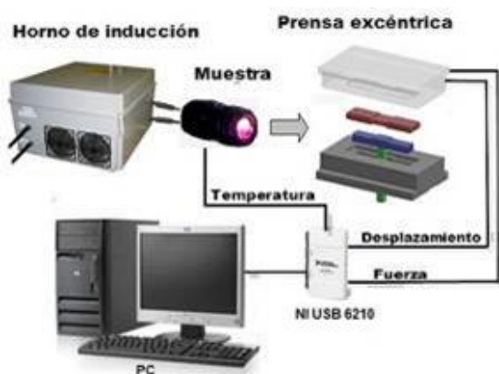
Figura 1. Esquema de la instalación experimental.
